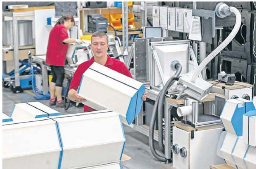
Mit der Produktion von Wärmetauschern – hier Mathias Helmrich bei der Dichteprüfung – hat die Firma Paul begonnen. Inzwischen hat sie ihre Produktpalette deutlich erweitert.
